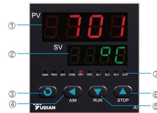
注：仪表上电后，仪表上显示窗口显示测量值(PV)。该显示状态为仪表的基本显示状态。输入的测量信号超出量程时（热电偶断线时，热电阻断线或短路时及输入规格设置错误时可能发生），则上显示窗交替显示“orAL”字样及测量上限或下限值。
