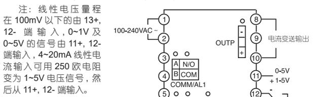
注: 线性电压量程在 100mV 以下的由 13+, 12- 端输入, 0~1V 及 0~5V 的信号由 11+, 12- 端输入, 4~20mA 线性电流输入可用 250 欧电阻变为 1~5V 电压信号, 然后从 11+, 12- 端输入。
