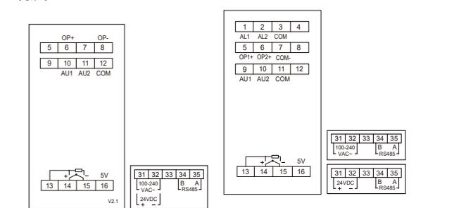
注 1: 0-5V/1-5V 从 15-, 16+ 输入, 100mV 以下从 14+, 15- 输入, 4-20mA 线性电流输入用 250 欧电阻变为 1-5V, 然后从 15-, 16+ 输入。
