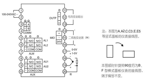
注: 线性电压量程在 1V 以下的由 19+, 18- 端输入, 0-5V/1-5V 的信号由 17+, 18- 端输入, 4~20mA 电流可外接 250 欧精密电阻分流后从 17+, 18- 端输入; 在 MIO 位置安装 I44 模块后, 电流信号可由 14+, 15- 输入, 也可直接从 16+, 14- 接二线制变送器。
